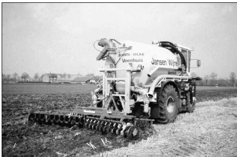
Figura 2.43: Equipo de incorporación en combinación con una cisterna grande [197, Holanda, 2002]
