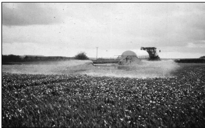
**Figura 2.39: Ejemplo de una técnica de diseminación por aspersión con baja trayectoria y a baja presión**
