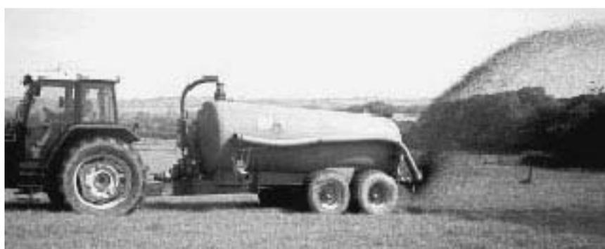
**Figura 2.36: Ejemplo de un esparcidor por aspersión con un plato difusor**
