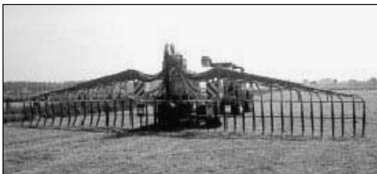
**Figura 2.40: Ejemplo de un difusor de bandas equipado con distribuidor rotatorio para mejorar la distribución lateral**
