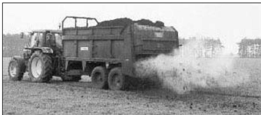
**Figura 2.45: Ejemplo de esparcidor de descarga trasera**
