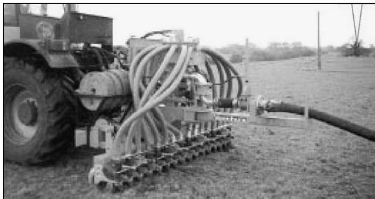
**Figura 2.42: Ejemplo de un inyector de surco abierto poco profundo**
