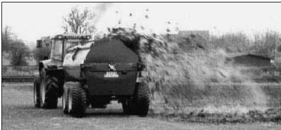
**Figura 2.44: Ejemplo de esparcidor rotatorio**
